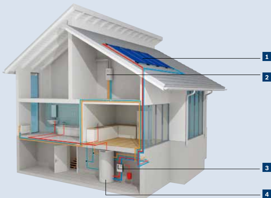
1 太阳能板 2 冷凝式燃气采暖热水炉 3 太阳能工作站，包括含膨胀箱、太阳能控制装置 4 太阳能储存装置
